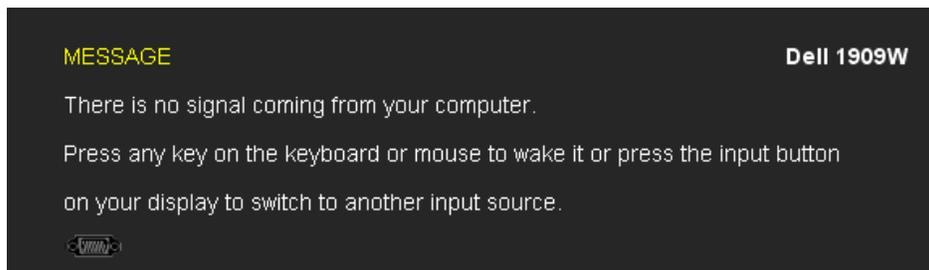
VGA 입력 또는 DVI-D 입력을 선택한 상태에서 VGA 케이블과 DVI-D 케이블 모두를 연결하지 않은 경우 아래 그림과 같이 움직이는 대화상자가 표시됩니다.
