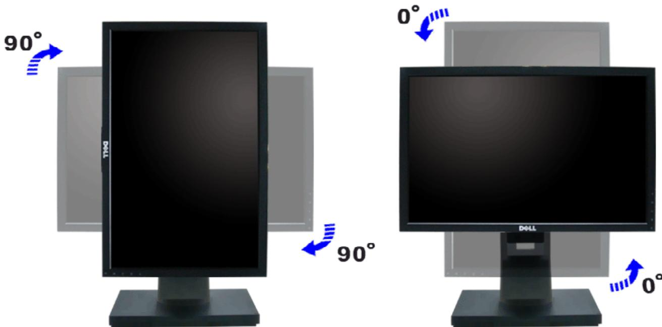
**참고:** 델 컴퓨터에서 디스플레이 회전 기능을 사용하려면 (가로 보기 대 세로 보기) 이 모니터에 포함되지 않은 업데이트된 그래픽 드라이버를 설치해야 합니다. 이 그래픽 드라이버를 다운로드하려면 [support.dell.com](http://support.dell.com)에 접속하여 비디오 드라이버의 다운로드 섹션에서 최신 드라이버 업데이트를 확인하십시오.
